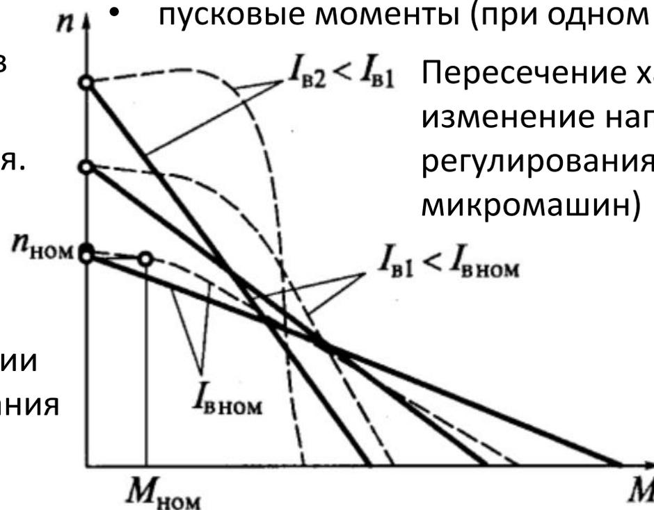
Пересечение хар-к – изменение направления регулирования (для микромашин)
