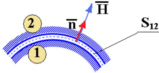
Рис. 6.2. Частный случай:  $\bar{H} = \bar{n}H$ ,  $\bar{T}_M = \bar{n}T_M$
