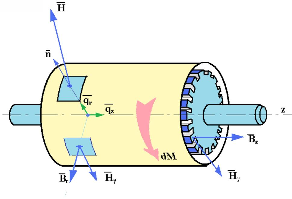
**Рис. 6.1. К определению максвелловских натяжений в активной и в торцевой зонах вращающейся электрической машины**
