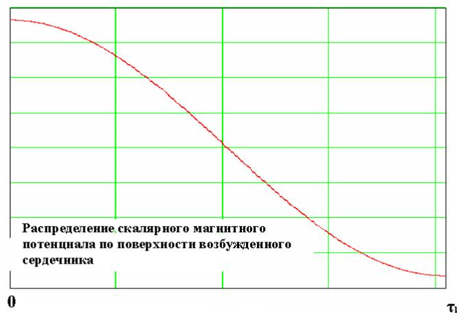
**Рис. 8.4. Гармоническое распределение потенциала на поверхности возбужденного сердечника и картина поля в равномерном воздушном зазоре**
